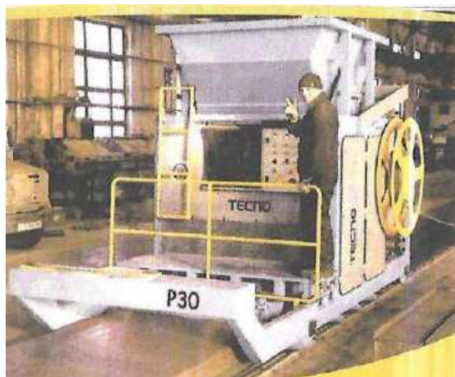
Рис. 8. Линия непрерывного формования плит перекрытий
